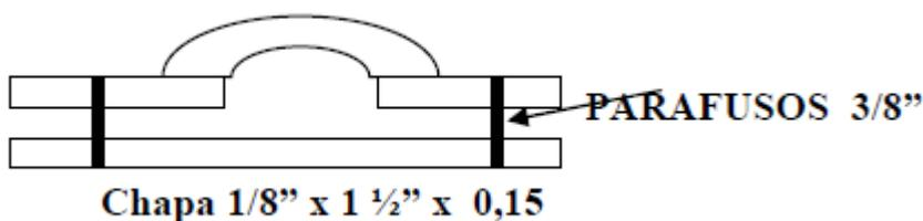
Perfil em L de 1"1/4" x 1/8" x 1,50, e 1"1/4" x 1/8" x 3,00m m com quatro furos com Ø de 1/4", duas braçadeiras cada perfil, com parafusos para placas com dimensão 1,5 x 3,0 m, placas para semipórticos.
